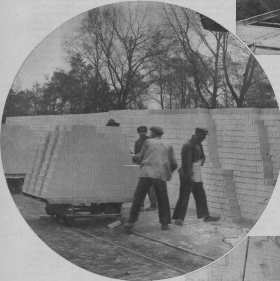
De steenen die in de verhardingsketels 8 uur lang onder stoomdruk hebben gestaan zijn gereed. Links: de producten van een dag wordt opgetast.
