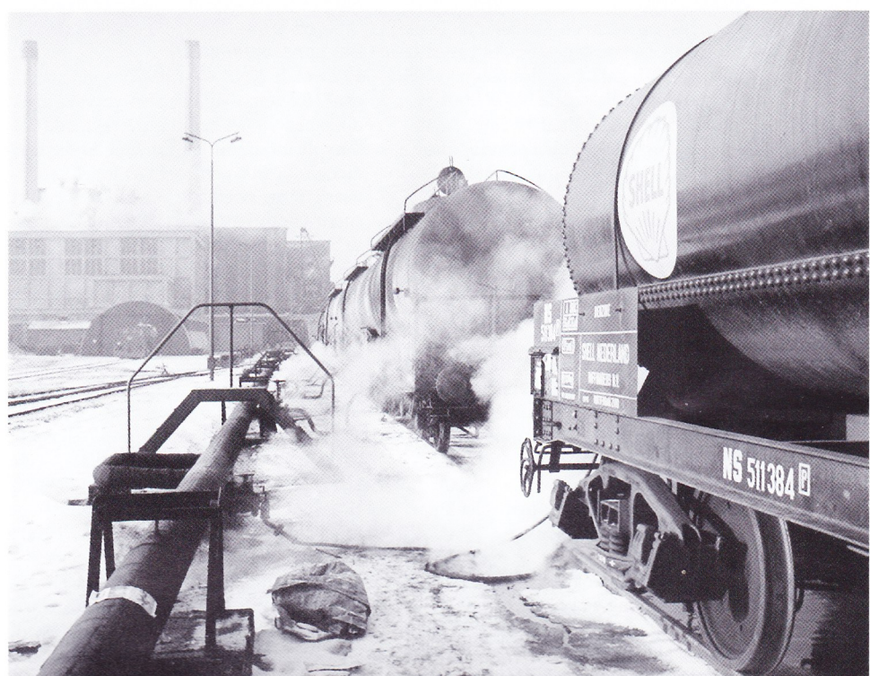
Benzinewagens van Shell (met Amerikaanse draaistellen) met stookolie worden met stoom gelost bij de KNZ; winter 1963. Foto: KNZ.
